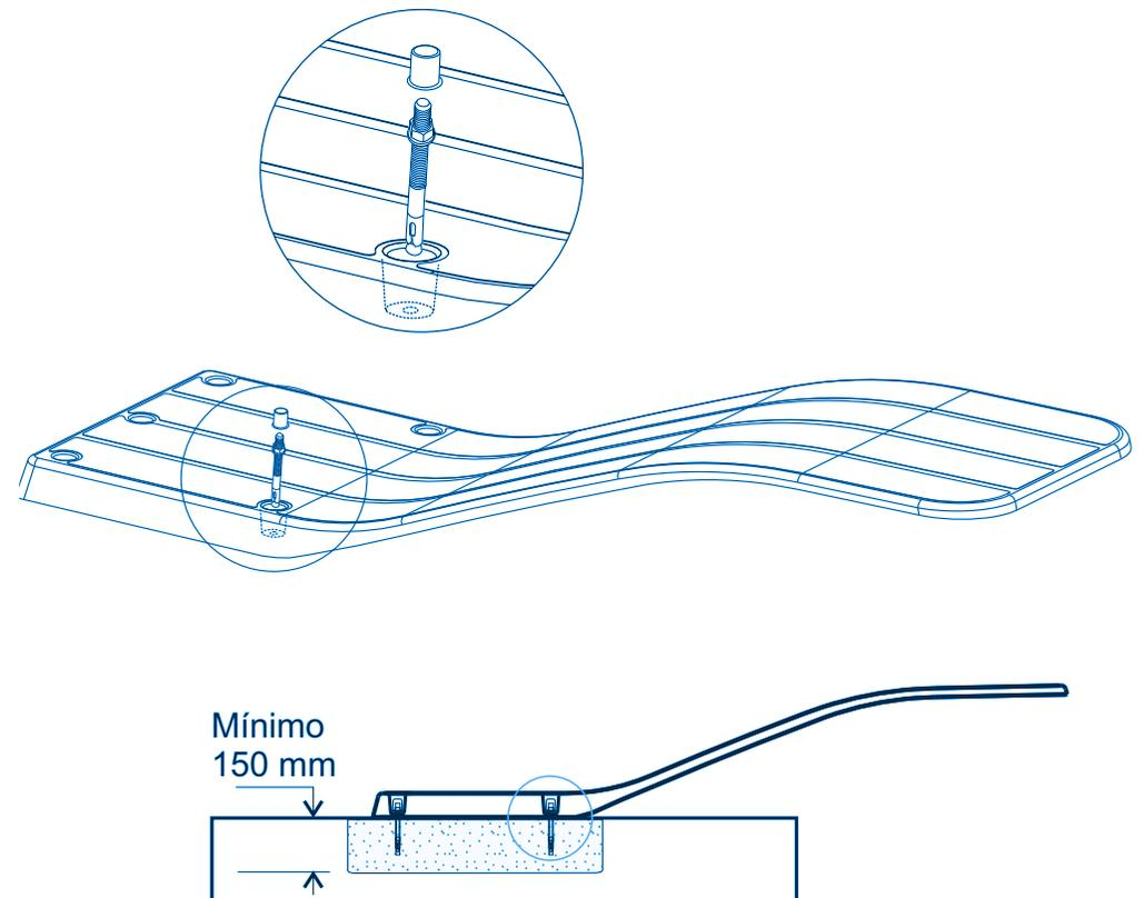
\* La cimentación para la instalación debe cumplir como mínimo con las características del hormigón C20/25 según la norma ENV206.
